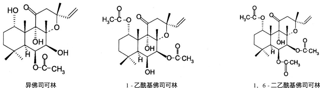
图 1 异佛司可林, 1-乙酰基佛司可林, 1,6-二乙酰基佛司可林的化学结构
